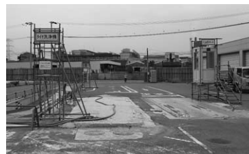
湿式自動タイヤ洗浄機・トラックスケール計量機 (10/6撮影)
