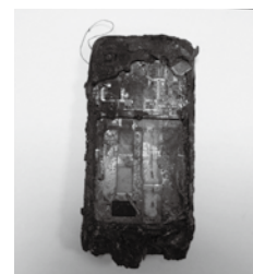
リチウムイオン電池から出火したスマートフォン
