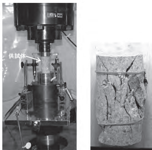
図 8-3 試料を装填した一軸圧縮装置（左）と破壊された試料（右）
