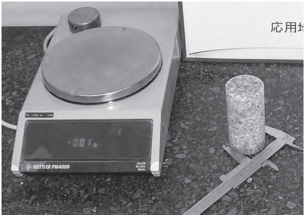
図 8-2 密度試験用供試体と測定器具
