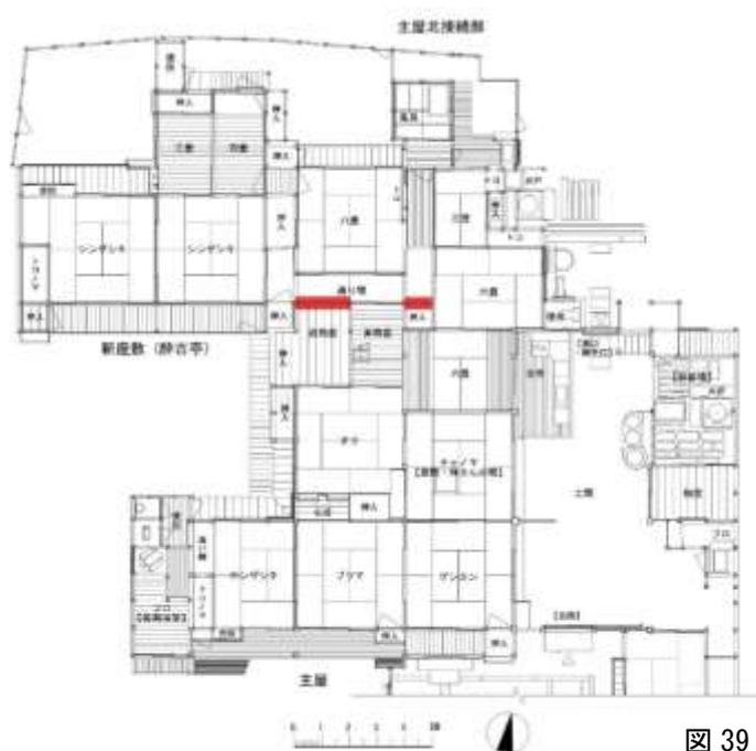
図 39 耐震壁設置案位置図
