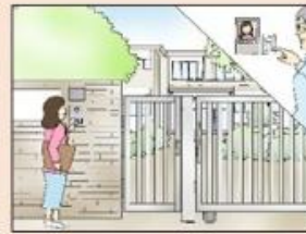
・校門の電気錠システムによる開錠管理
