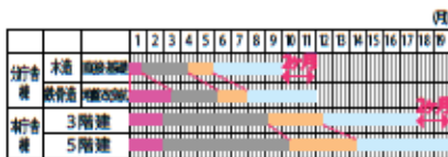
各庁舎棟工事工程の構造・規模による比較グラフ
